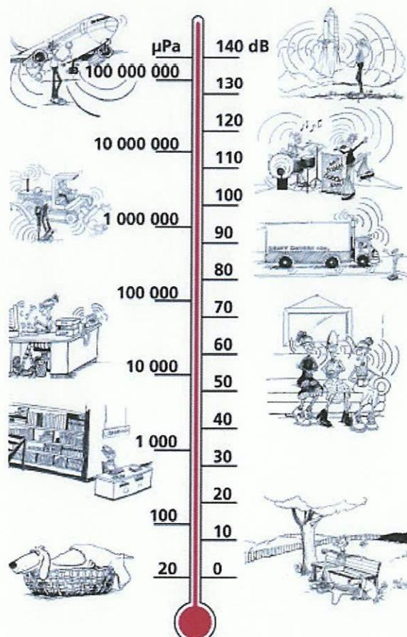
Povećanje nivoa zvučnog pritiska 10 puta, označava dodavanje (povećavanje) nivoa zvuka za 20 dB. Brojevi na skali u dB predstavljaju odnos sa dogovorenim referentnim nivoom koji iznosi 20  $\mu\text{Pa}$  (prag čujnosti), tj. 0 dB.
